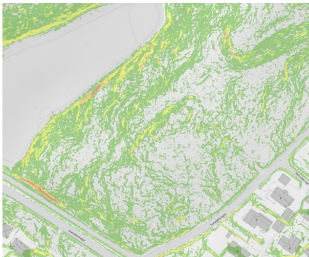
Figur 7 Hellingsskilt Lys grønn: 25-30 grader. gul 30-45 grader, oransje 45-60 grader, rød 60-90 grader (www.nve.no).
