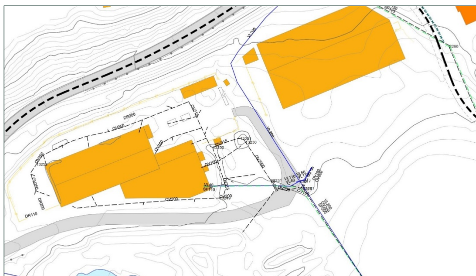
Figur 3-5: Eksisterende VA-ledninger i området
