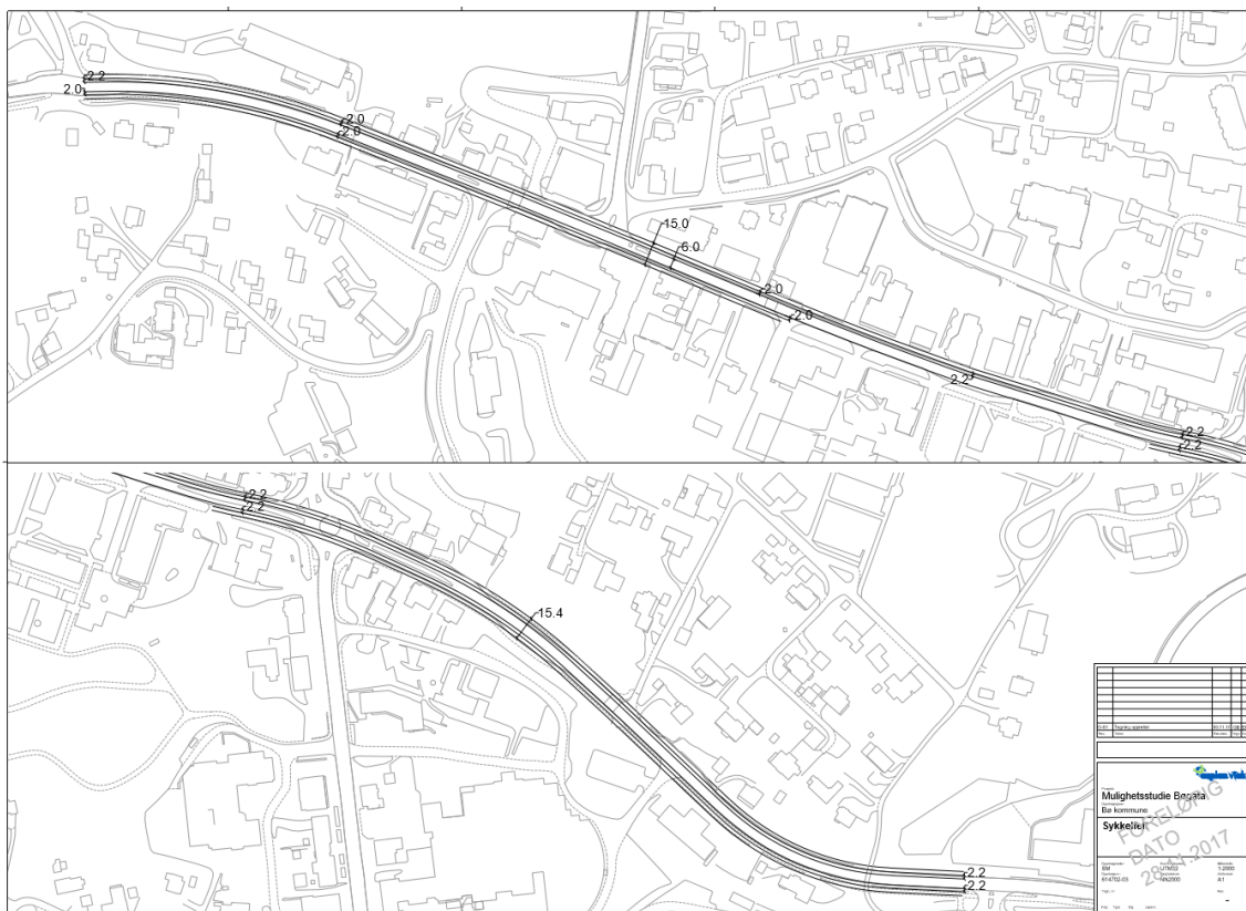
Figur 24: Plantegning av sykkelfelt og fortau i Bøgata
