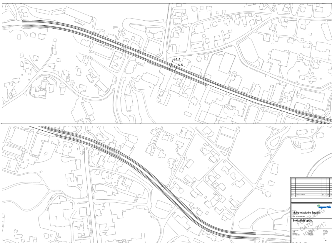
Figur 20: Plantegning av opphøyd sykkelfelt og fortau i Bøgata
