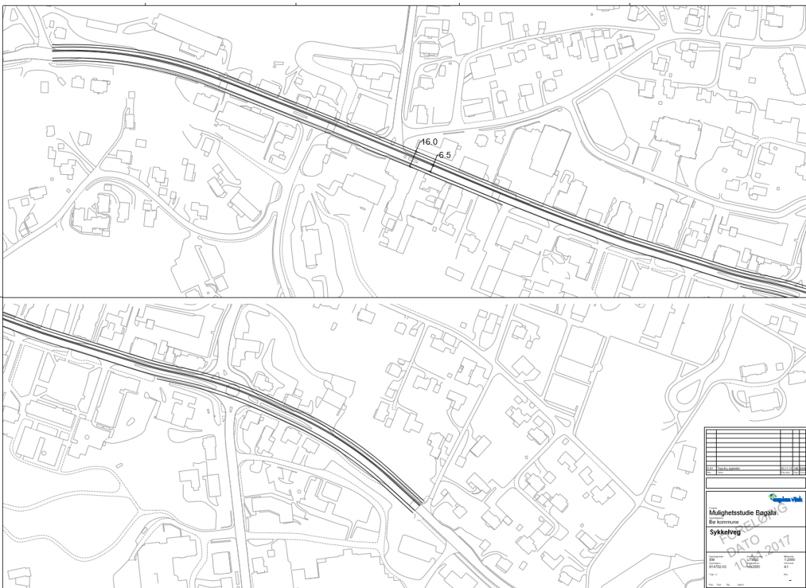
Figur 31: Plantegning av sykkelveg med fortau i Bøgata
