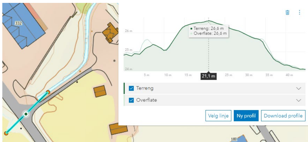
Figur 18: Utklipp fra Høydedata med profil over Rv36, der kulverten ligger. Ny g/s-veg langs rv36 som ligger noe høyere enn rv36 vises ikke i figuren.
