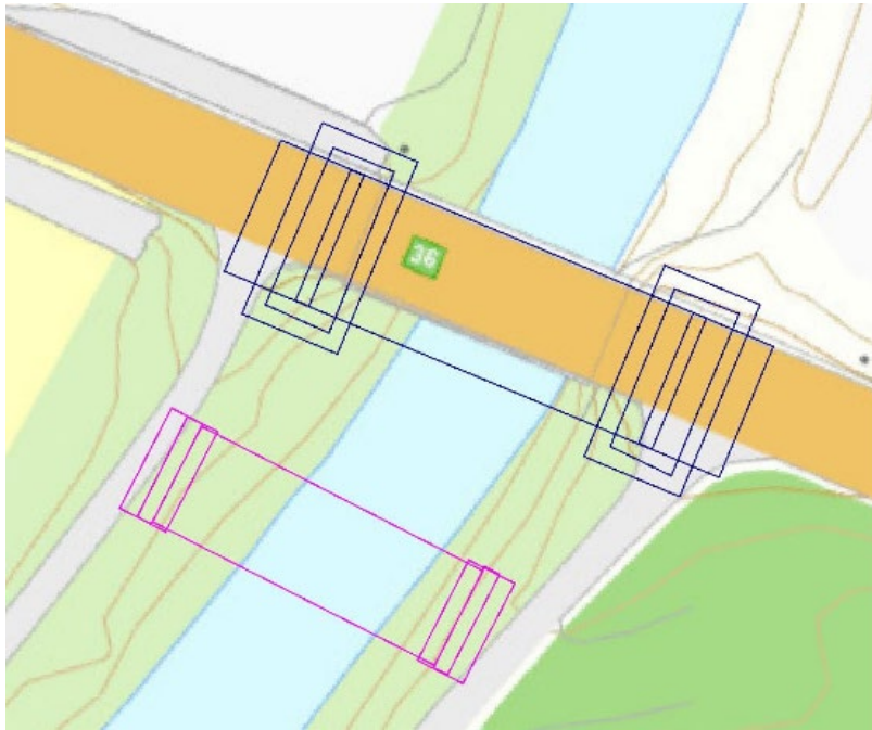
Figur 52: Lokalisering av ei mellombels bru (rosa linje) for omkøyning i samband med anleggsfasen.
