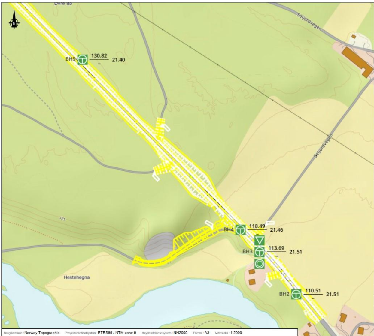
Figur 3-3: Plassering av de utførte grunnundersøkelsene i Verpe mellom Pr.2700 og Pr.3300. (BH2 til BH5).
