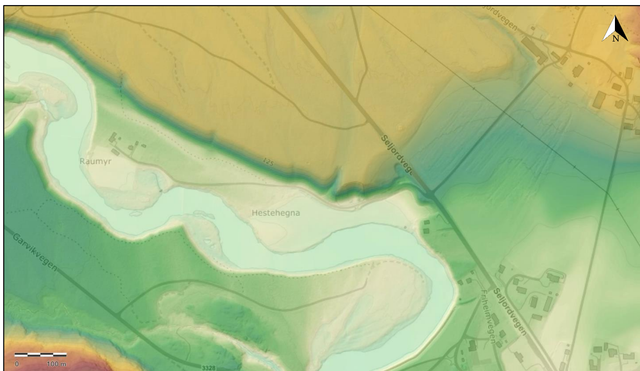
Figur 3-5: Oversikt over terrenghøyder i området med sprøbruddmaterialer [6]. Mørkere farger (gul og rød) indikerer områder som ligger høyere enn de lavere områdene (grønt).
