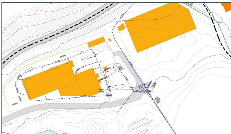
Figur 3-5: Eksisterende VA-ledninger i området
